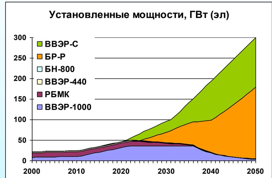
Замкнутый топливный цикл. Новое строительство – реакторы ВВЭР, быстрые реакторы БР-Р, с 2020 г. модернизированный ВВЭР-С с повышенным воспроизводством (до 0,8).
