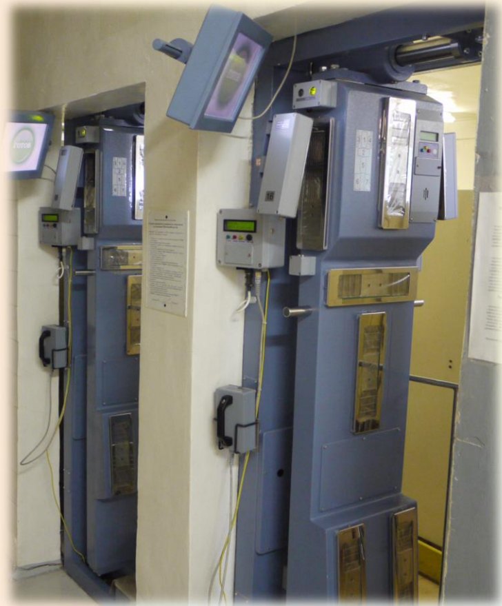
Радиометр загрязненных поверхностей РЗБА «Позитрон»
