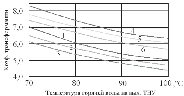
Рис. 2. Сравнение коэффициентов трансформации ЭТНУ и ГТНУ при t_o = 15^\circ\text{C} ; (1, 2, 3 – ЭТНУ при t_{w1} = 5^\circ\text{C} ; 10^\circ\text{C} ; 15^\circ\text{C} ; 4, 5, 6 – ГТНУ при t_{w1} = 5^\circ\text{C} ; 10^\circ\text{C} ; 15^\circ\text{C} )
