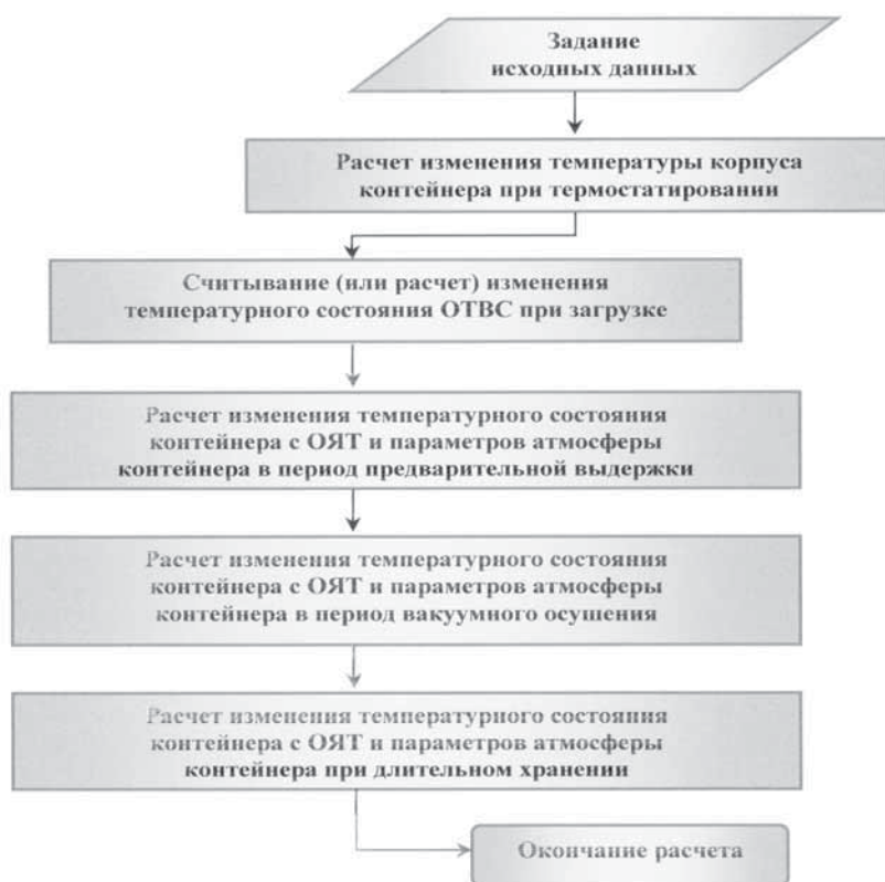
Рис. 1. Общая блок-схема алгоритма сквозного расчета тепловых процессов контейнера УКХ-109
