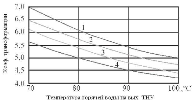
Рис. 1. Зависимость коэффициента трансформации ТНУ от температуры нагреваемой воды на выходе при следующих параметрах: t_o = 15^\circ\text{C} ; 1- t_{w1} = 5^\circ\text{C} ; 2- t_{w1} = 10^\circ\text{C} ; 3- t_{w1} = 15^\circ\text{C} ; 4- t_{w1} = 20^\circ\text{C} .
