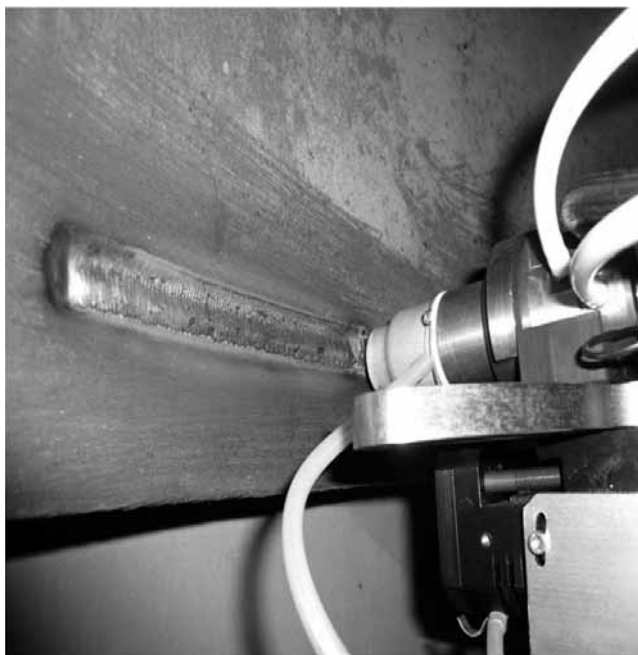
Рис. 3. Установка для автоматизированной наплавки выхлопных патрубков турбины
