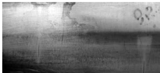
Рис. 4. Участок зоны ТВЧ рабочей лопатки с искусственными несплошностями глубиной 100мкм и 200мкм (ширина раскрытия 70мкм)
