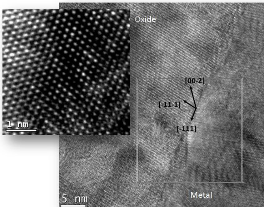
Система TITAN STEM позволяет определять в атомном масштабе точную природу оксидных плёнок, сформированных на поверхности 600 сплавов в условиях, близких к первому контуру ВВЭР
