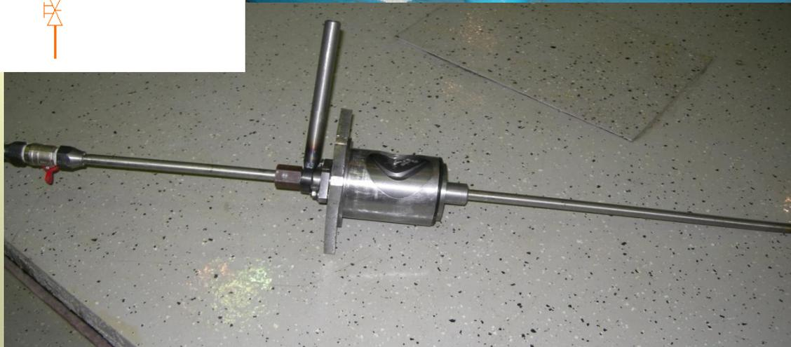
**В основе пневмогидроимпульсного способа очистки маслопроводов и оборудования систем маслоснабжения турбоагрегатов лежит гидродинамический способ промывки - прокачка масла по организованным контурам со скоростями в 2-4 раза превышающими скорость масла при гравитационной схеме.**
