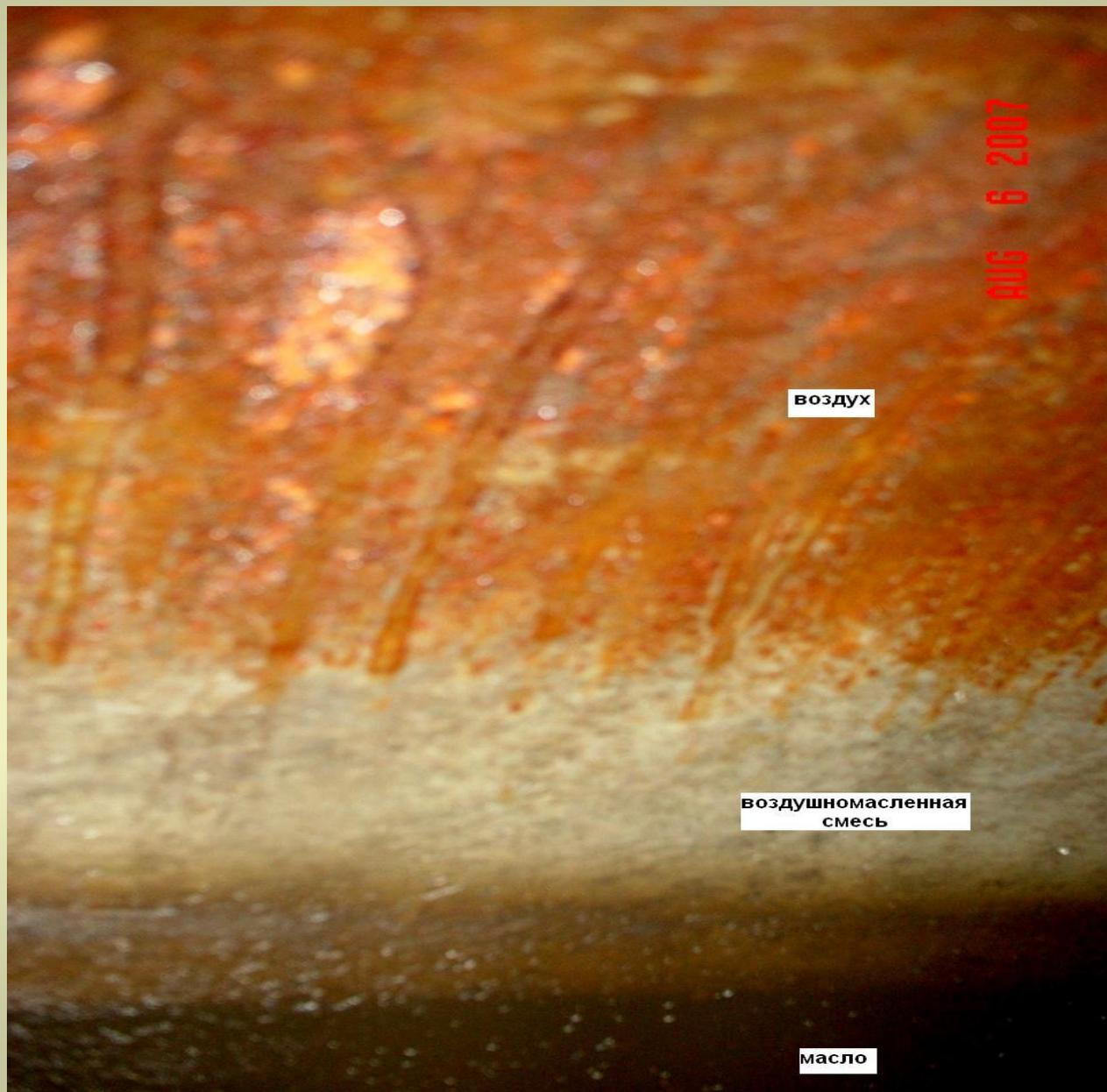
На слайде представлен сливной маслопровод 5-го и упорных подшипников турбины К-500-65/3000, где отчетливо видны границы контакта сред: масло (в нижней части) – (в середине) воздушно-масляная смесь – (и верхней части) воздух.
