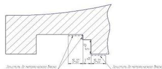
Рисунок 2 - Проточка под наплавку расточки ЦВД под обойму КУ № 1
