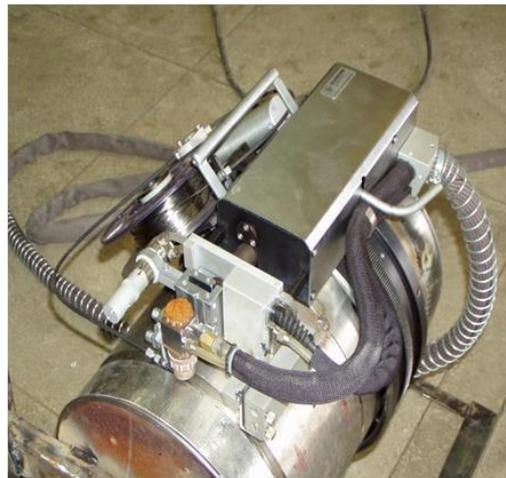
Высокотемпературная обработка (1050°C) СС приварки днищ РГК на АЭС с РБМК-1000
