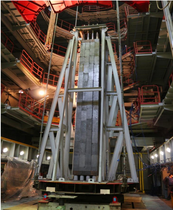
Общий вид МГК на сейсмоплатформе
